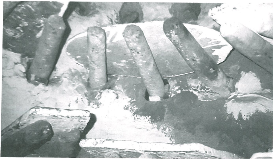
نمایی گویا از میخ‌های سفالی جدا از هم در کوره‌هایی که فاصله میخ‌ها با طبقات سفالی پر می‌شود A clear view of the separate earthenware bars of kilns in which gaps are filled with earthenware shelves Source: Kebabian, 2003, p.57.
