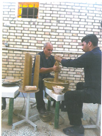
ساخت میخ‌های سفال Making the earthenware bars
