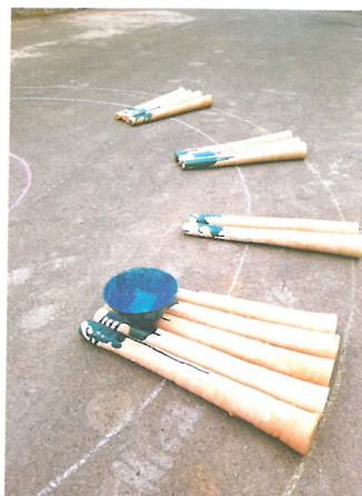
ساخت الگو برای نحوه قراردادن میخ‌های جدید سفالی به عنوان طبقه در کوره Making a model for inserting the earthenware bars functioning as shelves in the kiln
